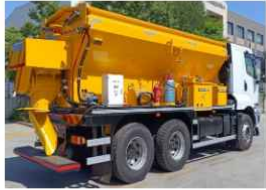
1 Adet Asfalt Yama Robotu
